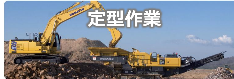
| 自走式破砕機への積込
