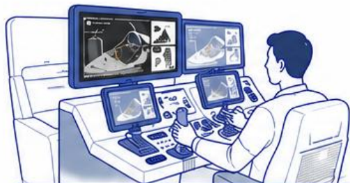
遠隔施工コックピット（省人化運用）
