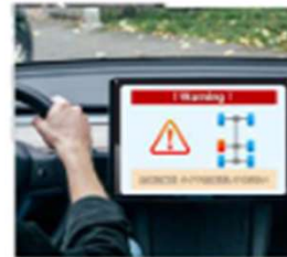
車輪脱落予兆検知装置
